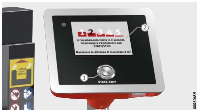
Trascorso il tempo di conto alla rovescia, si crea il campo elettromagnetico e il cuscinetto volvente viene riscaldato.
